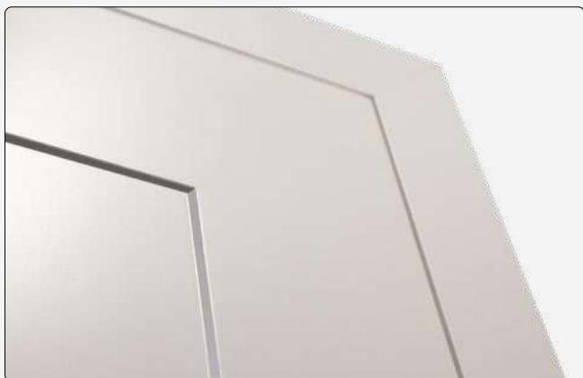
Classique Nouveau 1 - Die absolut eckig ausgeführte Kassettierung wird nicht gefräst, sondern mit Lasertechnik aus einer Platte herausgeschnitten, die später auf das Türblatt aufgeleimt wird. Nur so kann diese perfekte Eckausführung erzielt werden.
